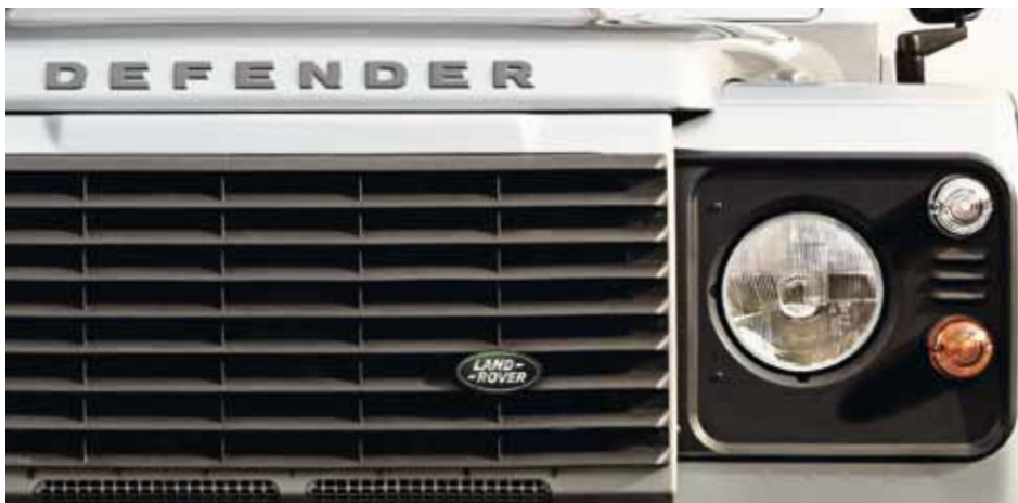
Zwarte kunststof grille met horizontale lamellen en zwarte kunststof koplampomlijstingen
