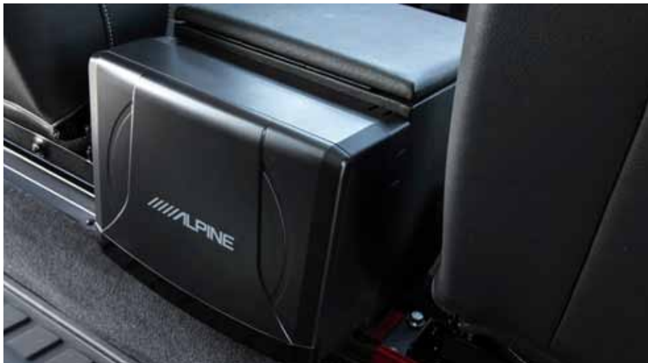
150 W subwoofer voor audiosysteem tegen achterzijde opbergvak ('cubby box').
