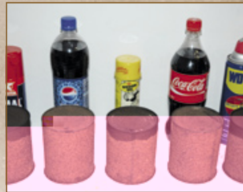
▲ Imal en WD-40 vloeien snel uit. De vette kruipolie van Kroon doet daar wat langer over, maar komt uiteindelijk net zover.
