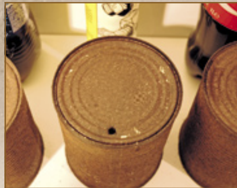
▲ De kruipolie van Kroon slaagde er als enige in wat blanke plekkjes te maken op de bodem van het conservenblik.
